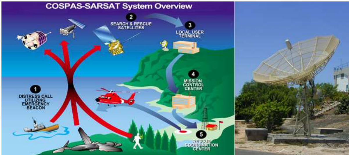
Ilustración 14: Sistema COSPAS-SARSAT y la antena de seguimiento en Maspalomas (Fuente: INTA)
